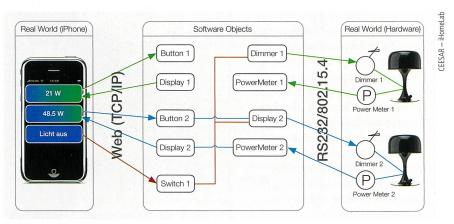
**Bild 3** Funktionsdiagramm des Energiemessdimmers.
