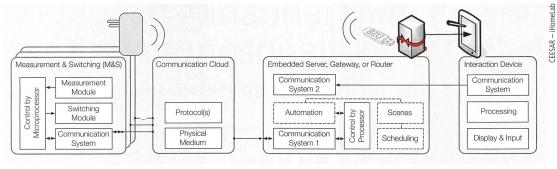
**Bild 2** Beispielhaftes Komponentendiagramm (hier: Plugwise).
