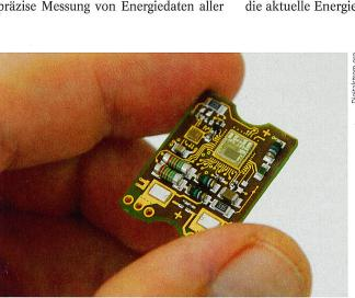
Bild 1 Digitalstrom-Aktor-Chip.
