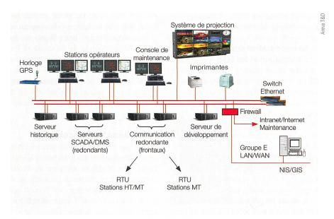
Figure 3 Architecture de la plate-forme SCADA EMS/DMS.
