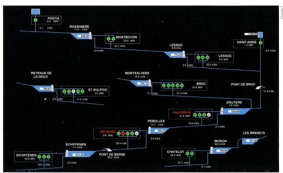
**Figure 4** Modélisation de la cascade hydraulique.
