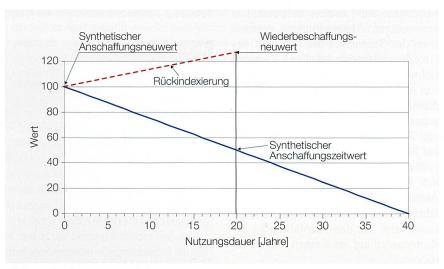
Bild 1 Anlagebewertung nach der synthetischen Methode.
