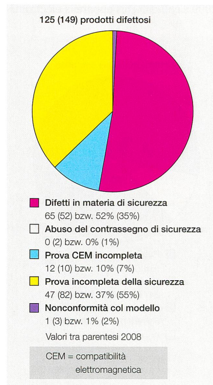
Figura 2 Suddivisione dei risultati dei test secondo il genere dei difetti.
