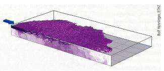
Bild 7 Momentanaufnahme von Sedimentpartikeln (z.B. Sand) in einer Flusseinmündung nach Vermischung mit dem Salzwasser des Meeres. Die Süsswasser-Partikel-Mischung ist in der Regel leichter
