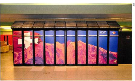
Bild 1 Der Monte Rosa am CSCS in Manno. Der schwarze Kasten rechts ist die Freon-Kühleinheit.
