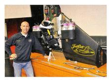
Yves Rossy mit dem aktuellen Prototyp. Die 4 Triebwerke liefern einen Schub von 88 kg und ermöglichen einen Steigflug mit 180 km/h.
