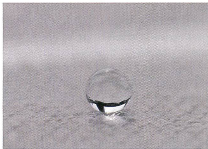
Der Wassertropfen bleibt als Kugel auf dem wasserabweisenden Gewebe stehen.
