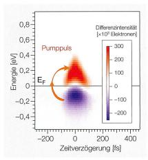
**Bild 6** Serie von Differenzspektren eines Nickelfilms, aufgetragen gegen die Zeit (horizontale Achse) und die Energie (vertikale Achse). Am Zeitnullpunkt (Pumppuls) werden Elektronen aus besetzten Zuständen unterhalb der Energie EF (Fermienergie) in unbesetzte Zustände oberhalb angeregt.
