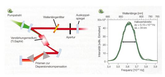
**Bild 1** Schematischer Aufbau eines Titan-Saphir-Lasers (a) und Spektrum der Lichtpulse (b).
