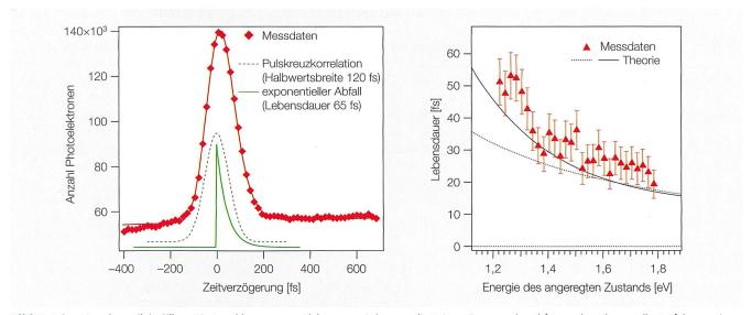
**Bild 5** Relaxationsdynamik in Silber: Die Anzahl angeregter Elektronen wird gegen die Zeitverzögerung des Abfragepulses dargestellt. Entfaltung mit der bekannten Pulskorrelationsfunktion liefert die gesuchte Besetzungskurve des angeregten Zustands (grüne durchgezogene Kurve). Die Ergebnisse zeigen, dass die Lebensdauer mit wachsender Energie abnimmt (rechts).
