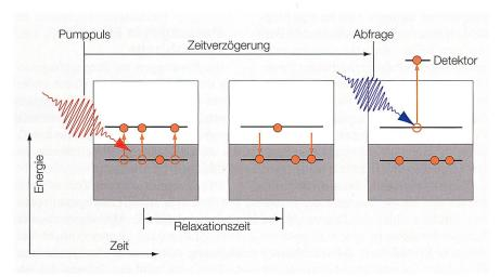
**Bild 3** Schema des Pumpabfrageverfahrens: Mittels eines Pumppulses werden Elektronen angeregt, wonach die angeregten Zustände zerfallen. Mit dem zeitverzögerten Abfragepuls misst man die im angeregten Zustand verbliebene Zahl der Elektronen.
