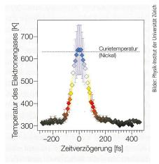
**Bild 7** Bestimmung der Temperatur des Elektronensystems aus den Spektren als Funktion der Zeit. Die Curietemperatur bezeichnet die Temperatur, oberhalb derer die ferromagnetische Ordnung in Nickel verschwindet. Man erkennt, dass das freie Elektronengas über die Curietemperatur aufgeheizt wird und sich innerhalb von 200 fs wieder abkühlt.
