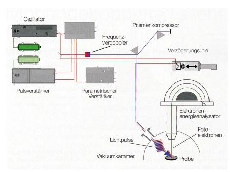
**Bild 4** Typischer Aufbau eines zeitaufgelösten Fotoemissionsexperiments: Lichtpulse aus einem Oszillator (Verstärker, halb transparent dargestellt) werden in zwei Pulse geteilt (Pumppuls und Abfragepuls). Je nach Bedarf kann die Frequenz der Pulse z.B. in doppelbrechenden Kristallen vervielfacht werden.
