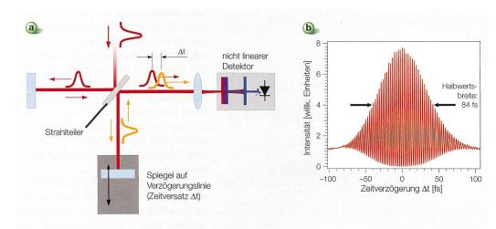
**Bild 2** Aufbau (a) und Ergebnis (b) eines Autokorrelationsexperiments: Ein Puls wird in zwei identische aufgeteilt, die über verschiedene Wege laufen und nachher im Zweiphotonendetektor zur Interferenz gebracht werden (a). Im Detektorsignal (b) sind die Interferenzstreifen deutlich zu sehen; aus der Form und Breite der Kurve können Rückschlüsse auf die Pulsdauer der einzelnen Pulse gezogen werden.
