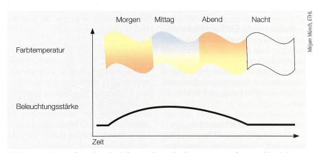
**Bild 3** Beispiel eines (hypothetischen) dynamischen Beleuchtungsszenarios (bei ausschliesslicher oder komplementärer Kunstlichtbeleuchtung) mit wechselnder Farbtemperatur und Beleuchtungsstärken im Tagesverlauf (ohne Licht während der Nacht). Am Morgen und am Abend könnte eine schrittweise Sonnenaufgangs- bzw. -untergangs-Beleuchtung erfolgen.
