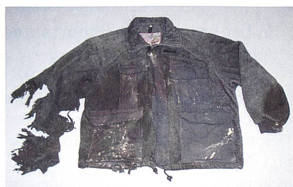
Figure 1 Veste de travail après action d'un arc électrique dans un tableau de distribution à basse tension.
