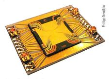
Atomchip für die Erzeugung von quantenmechanischer Verschränkung in Bose-Einstein-Kondensaten.
