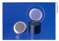
Ein mit dem neuen Verfahren hergestelltes Linsenarray mit entsprechendem Stempel.
