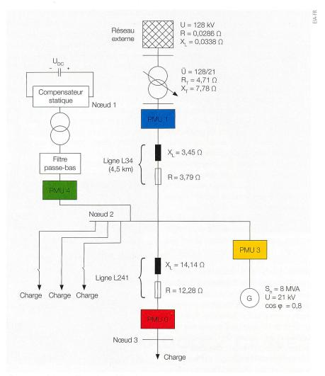
Figure 3 Schéma unifilaire du modèle réduit 400 V/5 A.
