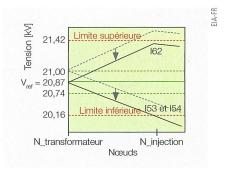
**Figure 5** 162: transformateur à gradins insuffisant.
