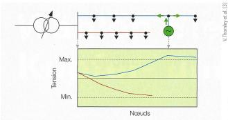
**Figure 2** Profils de tension avec et sans source additionnelle.
