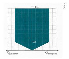
**Figure 6** Courbe P = f(Q) d'une génératrice d'éolienne.
