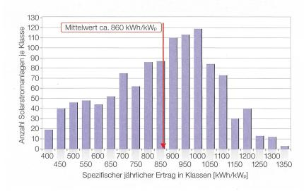
**Bild 1** Der mittlere spezifische Jahresertrag der Solarstromanlagen im Jahre 2009 betrug gute 860 kWh/kW $_{\rm p}$ . Er liegt unter anderem dank rund 3,0 % mehr Sonneneinstrahlung über dem langjährigen Mittel von 820 kWh/kW $_{\rm p}$ .
