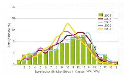
**Bild 2** Spezifische Jahreserträge der Solarstromanlagen, aufgeteilt in 50-kWh/kW<sub>p</sub>-Klassen (Balkendiagramm), im Vergleich zu den Werten der Vorjahre (Linien).
