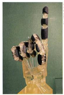
Die Finger der Roboterhand werden mit verdrillten Schnüren bewegt.
