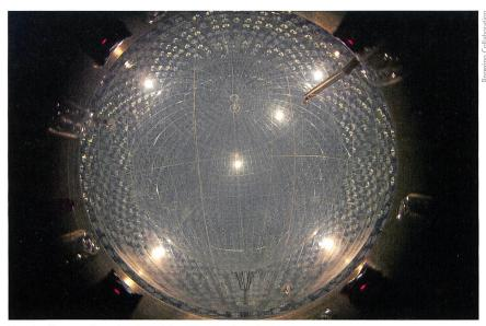
Vue du détecteur Borexino. La sphère a un diamètre de 14 m.
