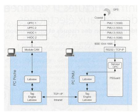
Figure 2 Structure IT du réseau de simulation (miniréseau).
