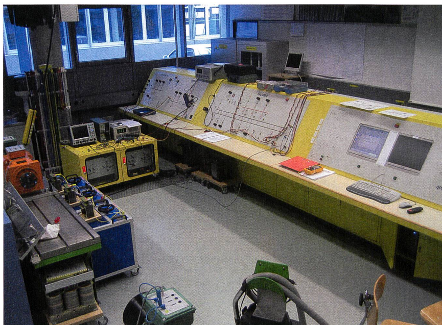
Figure 1 Miniréseau analogique de l'EIA-FR.
