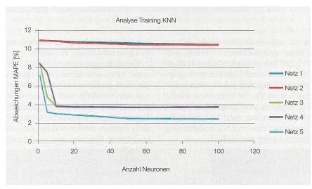
Bild 6 Prognosegüte MAPE in Abhängigkeit von der Anzahl Neuronen und der Inputfaktoren.
