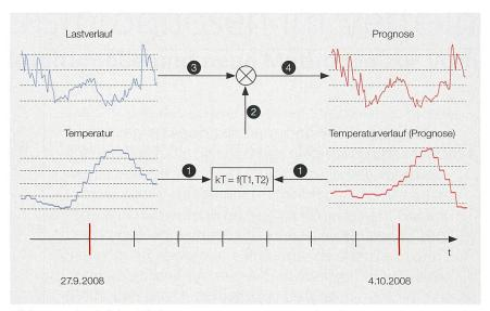
Bild 4 Vorgehen bei der einfachen Lastprognose mit Temperaturkorrektur.
