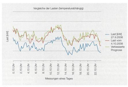
**Bild 5** Lastprognose mittels Temperaturkorrektur eines Referenztags.
