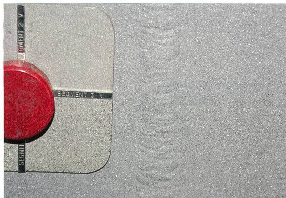
Bild 6 Detailaufnahme von der gereinigten Oberfläche mit ISO-Rauigkeits-Vergleichsmuster.
