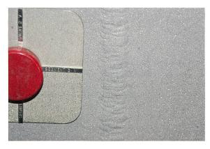
**Bild 6** Detailaufnahme von der gereinigten Oberfläche mit ISO-Rauigkeits-Vergleichsmuster.
