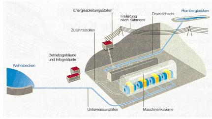
Bild 1 Aufbau des Kraftwerks.
