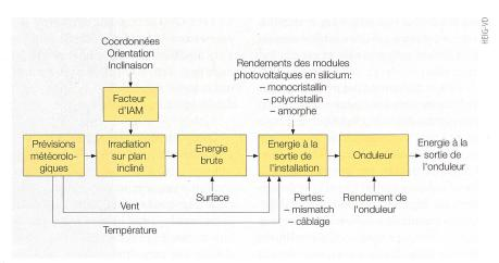
Figure 1 Schéma de principe de la modélisation.
