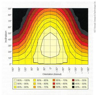
Figure 4 Irradiation solaire annuelle en fonction de l'orientation et de l'inclinaison d'une surface par rapport à l'irradiation solaire annuelle sur un plan positionné de manière optimale.
