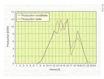
Figure 3 Comparaison entre la production d'électricité de la centrale de Corcelles-sur-Chavornay du 27 juin 2009 et la production modélisée avec les données météorologiques mesurées sur le site de la HEIG-VD.
