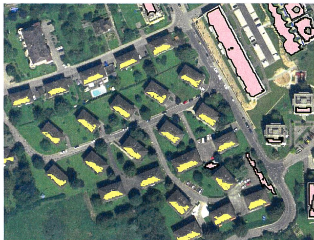
Figure 5 Illustration des résultats du logiciel de simulation ArcGIS après recherche selon les caractéristiques citées dans le texte. Les surfaces jaunes représentent les toits inclinés, alors que les surfaces roses correspondent à des toits plats.
