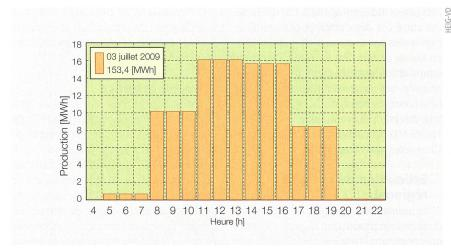
**Figure 6** Modélisation de la production d'énergie photovoltaïque pour le potentiel d'Yverdon-les-Bains selon les prévisions du 2 juillet 2009.
