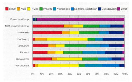
**Bild 1** Umweltbelastungsanteile der verschiedenen Prozessstufen bei der Produktion von Solarstrom in einer Schweizer 3-kW<sub>p</sub>-Schrägdach-Anlage mit multikristallinen Siliziumpaneelen. Bewertung mit ReCiPe Midpoint, World, H [3] und kumuliertem Energieaufwand [7].
