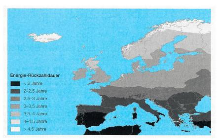
**Bild 3** Energie-Rückzahldauer von Fotovoltaikanlagen in Europa (Stromproduktion von 1 kW<sub>p</sub> Kapazität über 30 Jahre).
