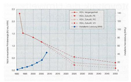
**Bild 2** Kumulierter Energieaufwand (KEA) aus fossilen und nuklearen Energieträgern pro kWh Solarstrom (MJ-eq./kWh, linke Achse) in Ökobilanzstudien für die Zeit zwischen 1992 und 2050 und installierte Fotovoltaik-Netzverbundanlagen in der Schweiz (MW<sub>p</sub>, rechte Achse) [8, 10–14]; PE: Szenario pessimistisch; RO: Szenario realistisch-optimistisch; VO: Szenario sehr optimistisch.
