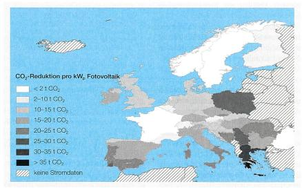
**Bild 4** Länderspezifisches Reduktionspotenzial der Treibhausgase mit Fotovoltaikanlagen (Stromproduktion von 1 kW<sub>D</sub> Kapazität über 30 Jahre).
