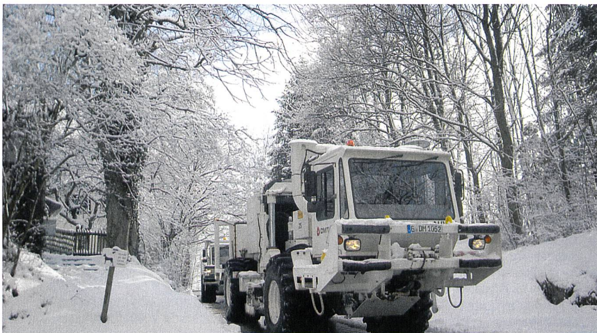
Vibrationsfahrzeuge unterwegs im Raum St. Gallen. Mit ihnen vermessen die Stadtwerke den Untergrund.
