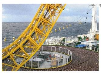
Die HGÜ-Kabel für den Stromtransport über das Meer werden mithilfe eines speziellen Verlegeschiffs auf dem Meeresboden platziert.
