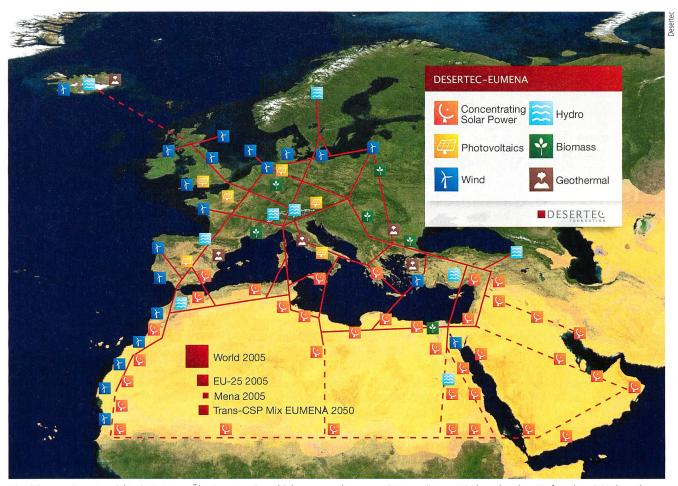
Die Vision von Desertec sieht ein Netz aus Übertragungs-Superhighways vor, das grosse Sonnenwärme-, Wind- und andere Kraftwerke mit Verbrauchsschwerpunkten verbindet.
