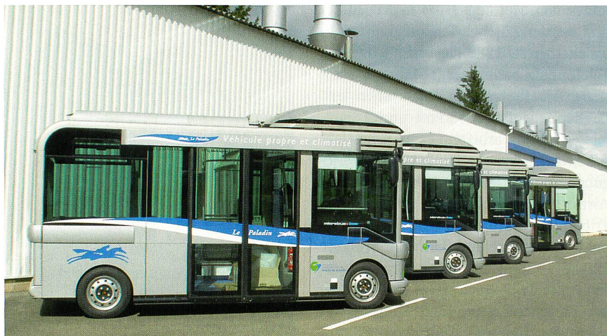
Seit Ende 2009 läuft die Serienfertigung des 22-plätzig Microbus. Die Leichtbau-Zellstruktur aus der Schweiz wird von Alcan geliefert.
