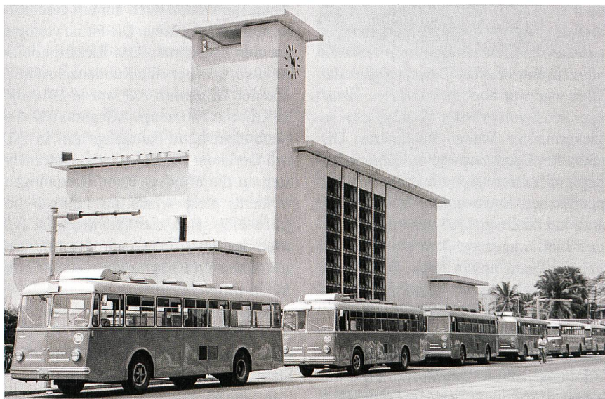
Für Léopoldville (heute Kinshasa) baute MFO 12 Gyrobusse, welche ab 1955 auf zwei Linien verkehrten.
