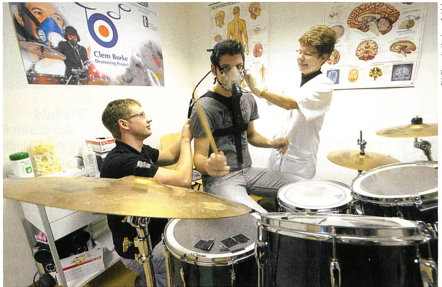
Puls, Laktatwerte und Atemgas des Schlagzeugers werden bei steigender Schlagzahl kontrolliert.
