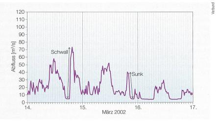
**Bild 1** Beispiel eines kraftwerkbedingten Schwall-und-Sunk-Ereignisses.
