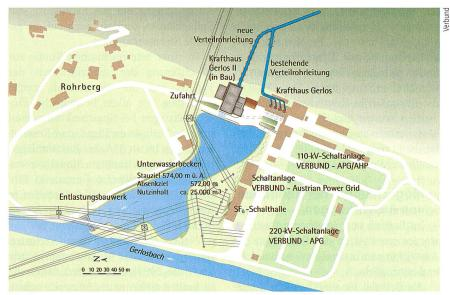
Bild 4 Systemskizze Schwallausgleichsbecken beim Kraftwerk Gerlos/Zillertal.
