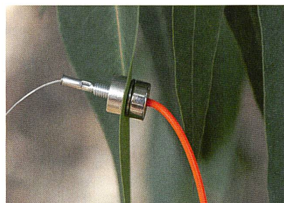
Das Blatt eines Eukalyptusbaums mit dem Magnetsensor zur Wasserbestimmung. Feuille d'eucalyptus avec capteur magnétique de détermination de la teneur en eau.
