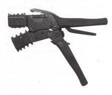
belverbinder (rot: 0,5–1,0 mm², blau: 1,5–2,5 mm², gelb: 4,0–6,0 mm²), als Crimpzange für unisolierte Kabelverbinder (z.B. Kabelschuhe, Aderendhülsen usw.), 1,5, 2,5, 6 und 10 mm², als Abisolierzange für 1,0, 1,3, 1,6, 2,0 und 2,6 mm² und als Schneider für mehrdrahtige Leiter (Litze).
