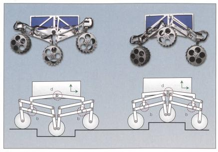
Bild 2 Kinematisches Modell der Forschungsplattform Crab.
