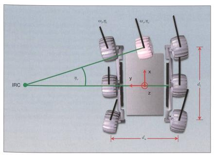
Bild 5 Die schematische Darstellung des Crabs veranschaulicht das Prinzip des virtuellen Rades (rosa) und des momentanen Rotationszentrums der Bewegung des Roboters (IRC).
