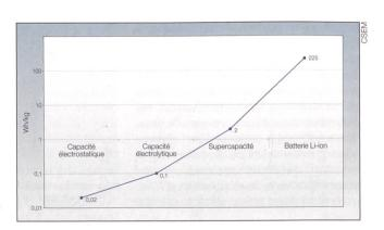
Figure 3 Evolution des capacités des systèmes de stockage d'énergie.
