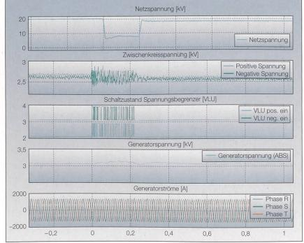
Bild 7 Wirkungsweise des Bremschoppers bei extremen Netzstörungen.
