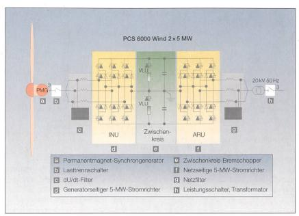
Bild 5 Prinzipschaltbild des 3-Punkt-Vierquadrantenumrichters.
