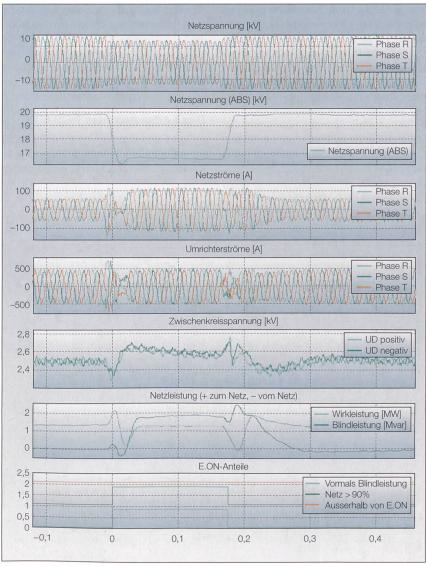
Bild 6 Flickeraufzeichnung bei E.ON mit dem ABB-DIAS-System.
