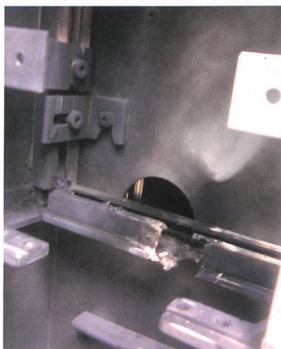
Figure 6 Le défaut à la terre a calciné un grand trou dans le cadre profilé et déchiré en deux le conducteur L3.
