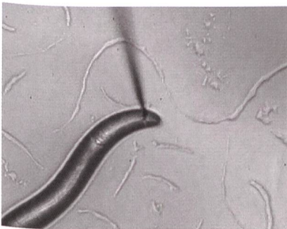
Bild 5 Das Tastempfinden des Caenorhabditis elegans wird mithilfe des MEMS-Mikrokraftsensors studiert.
