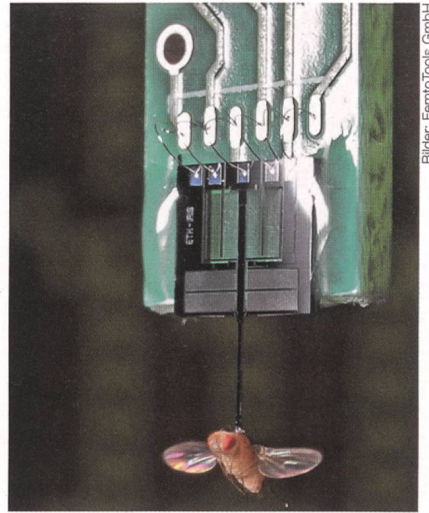
Bild 6 Die Flugkraft der Drosophila melanogaster wird gemessen, indem die Fruchtfliege an einen Kraftsensor geklebt wird.
