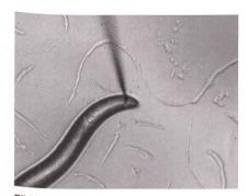
Bild 5 Das Tastempfinden des Caenorhabditis elegans wird mithilfe des MEMS-Mikrokraftsensors studiert.
