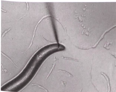
Bild 5 Das Tastempfinden des Caenorhabditis elegans wird mithilfe des MEMS-Mikrokräftensensors studiert.
