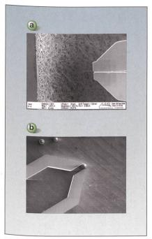
Bild 4 Handhabung von Siliziumnanoröhrchen (Bild 4a) und Glaskugeln (Bild 4b) im Rasterelektronenmikroskop.
