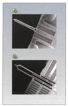
Bild 2 Rasterelektronenaufnahme eines Mikrokraftsensors (Bild 2a) und eines Mikrogreifers (Bild 2b).
