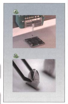
Bild 3 Mithilfe von Mikrogreifern lassen sich verschiedene Baugruppen (Bild 3a) und Bauteile (Bild 3b) mikrometergenau zusammensetzen und komplexe 3-dimensionale Strukturen herstellen.
