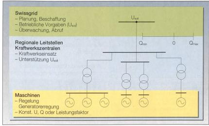
Bild 1 Organisation der Spannungshaltung im schweizerischen Übertragungsnetz.
