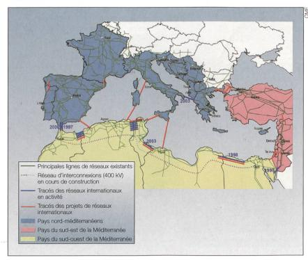
Figure 3 La boucle électrique méditerranéenne. Les tracés rouges illustrent les projets d'interconnexions des réseaux électriques en Méditerranée.
