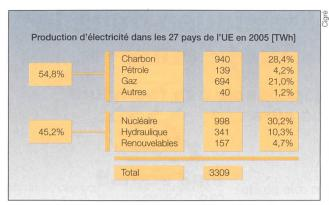
Figure 2 Répartition des différentes sources d'énergie utilisées pour la production d'électricité dans les 27 pays de l'UE en 2005.
