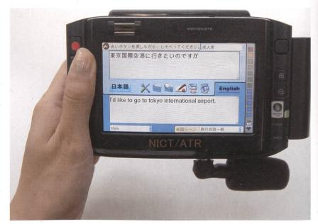
Bild 2 Ein Taschendolmetscher auf Basis eines handelsüblichen tragbaren Computers, entwickelt von NICT/ATR in Japan.
