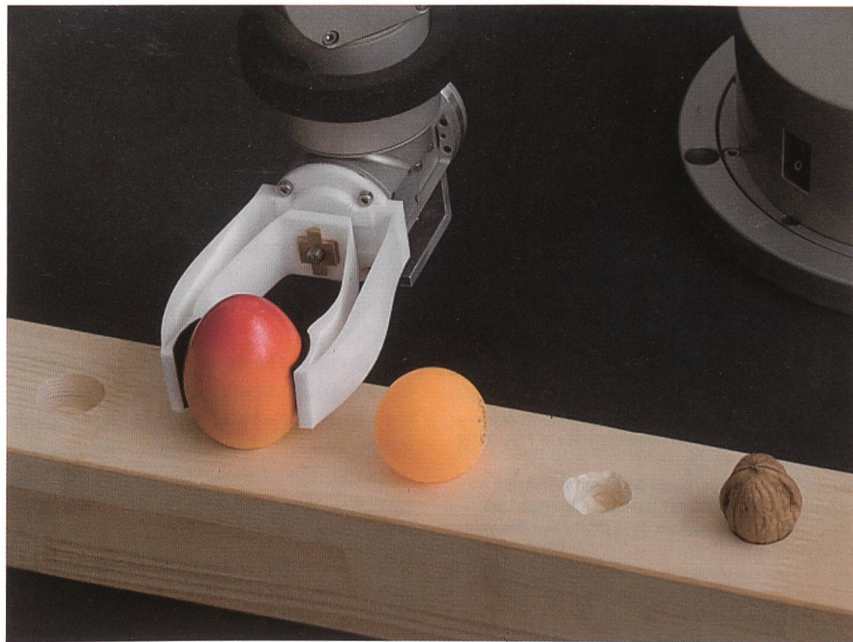
«Compliant Systems» – preiswerte Werkzeuge aus intelligenten Materialsystemen. Dieser Greifarm ist aus einem Guss gefertigt.
