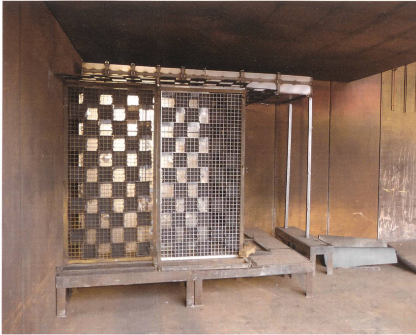
Bild 7 MS-Anlage VES-T; Druckentlastung nach oben über Ausleitkanal; IAC AFL 25 kA 1 s, Nachschuss zur Typprüfung nach SN EN 62271-200; A.3.2. (zusätzliche Prüfung mit reduzierter Deckenhöhe).
