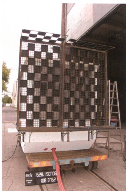
Bild 3 Prüffeld fabrikfertige Station, nicht begebar, vor «A-Schuss».
