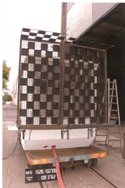
Bild 3 Prüffeld fabrikfertige Station, nicht begehbar, vor «A-Schuss».
