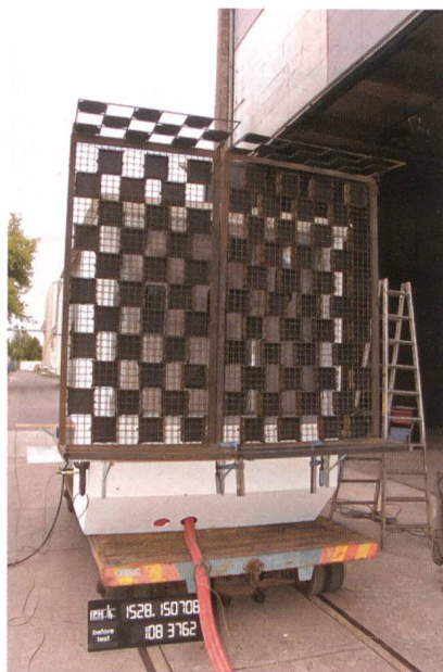
Bild 3 Prüffeld fabrikfertige Station, nicht begehbar, vor «A-Schuss».
