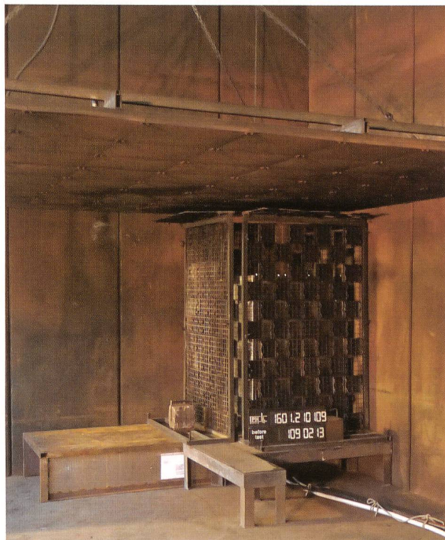
Bild 6 MS-Anlage Weva Compact; Druckentlastung nach unten; IAC AFL 20 kA 1 s, Nachschuss zur Typprüfung nach SN EN 62271-200; A.3.2. (zusätzliche Prüfung mit reduzierter Deckenhöhe).
