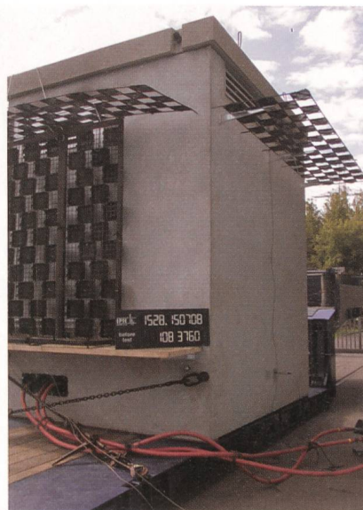
Bild 5 Prüffeld fabrikfertige Station, begehbar, vor «B-Schuss».
