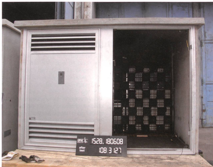
Bild 2 Prüffeld fabrikfertige Station, begebar, vor «A-Schuss».
