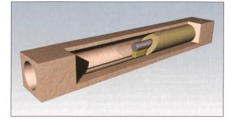
Bild 3 Lagerstollen für hochaktive Abfälle mit dem Lagerbehälter (grau) und dem Verfüllmaterial Bentonit (grün).
