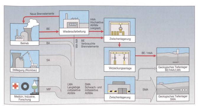
Bild 1 Das Konzept der nuklearen Entsorgung in der Schweiz: Die Pfeildicken entsprechen etwa dem jeweiligen Volumen der Abfallströme.
