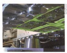
Neue Produktionstechnologien an der Productronica: Selektivlötanlage.
