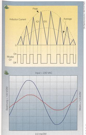
Bild 9 Stromverlauf des Mosfet (Bild 9a) und resultierende Spannungs- und Stromform (Bild 9b).
