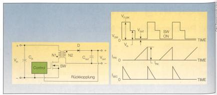
Bild 2 Prinzipschema eines Sperrwandlers (Switchmode Powersupplies, ON Semiconductor, 2002).
