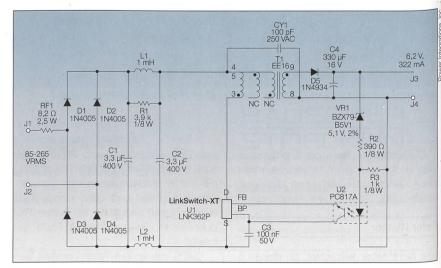
Bild 3 LinkSwitch-Sperrwandler mit galvanischer Trennung, Leistung ca. 2 W.
