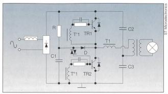
Bild 4 Prinzipschaltbild eines Half-Bridge-Wandlers.
