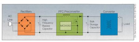
Bild 8 Prinzipschema einer aktiven Leistungsfaktorschaltung (Active PFC).
