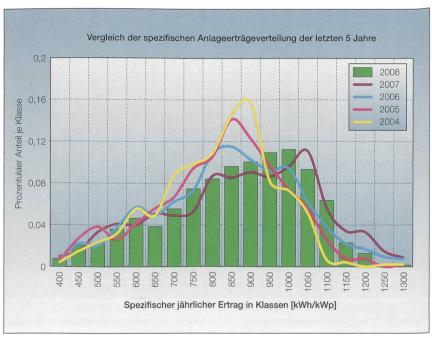
Bild 2 Spezifische Jahreserträge der Solarstromanlagen, aufgeteilt in 50-kWh/kWp-Klassen (Balkendiagramm), im Vergleich zu den Werten der Vorjahre (Linien).
