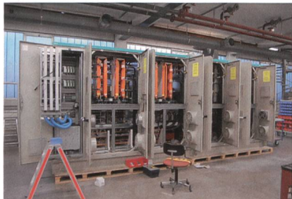
Schaltschrankmontage bei der Firma Simatex.
