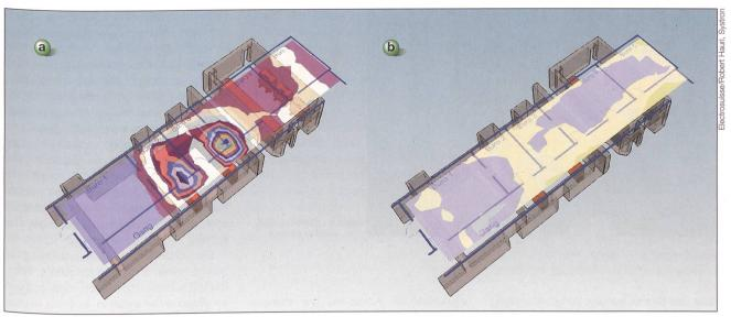
Bild 2 Messungen vor und nach dem Einbau der Abschirmungen. a) Vorher: Bei Nennlast max. Wert über Einspeisfeld =  $8.9 \, \mu T - b$ ) Nachher: Bei Nennlast an allen Orten im Bereich OMEN <  $1 \, \mu T$ .
