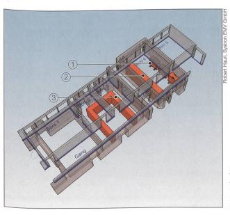
Bild 1 Grau: UG, Transformatorenstation. Blau: EG, Büros. 1) Transformatoren, 2) MS-Anlage, 3) NS-Hauptverteilung.
