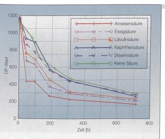
Bild 1 Papieralterung bei 130°C im Öl bei Zugabe von verschiedenen typischen Säuren (Säurezahl 0,4 mg KOH/g).
