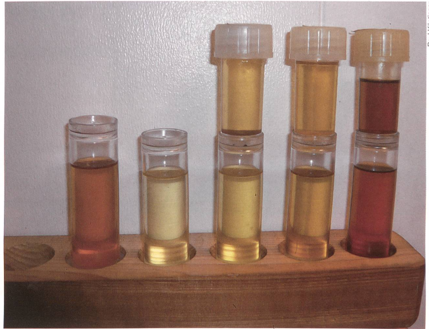
Bild 4 Ölproben vor, während und nach der Regenerierung mit der modernen Methode (v. r. n. l.).
