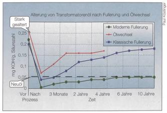
Bild 5 Langzeitvergleich der verschiedenen Methoden.
