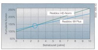
Bild 5 Beispielhafte Amortisationsrechnung bei 60% Last im Dauerbetrieb.
