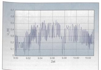
Bild 6 Verlauf der gestörten Verlagerungsspannung  $|U_0|$ .
