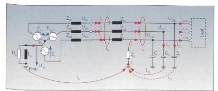
Bild 1 Einfaches Netz mit Erdschlusskompensation.
