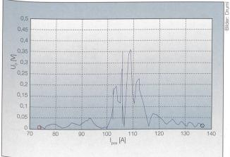
Bild 7 Gestörte Resonanzkurve.
