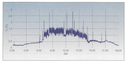
Bild 2 Übersprechen des Laststroms auf die Nullspannung.
