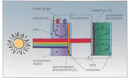
Figure 1 Cellule solaire tandem pour la production d'hydrogène.
