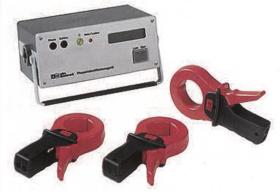
Phasenidentifikation für geerdete und kurzgeschlossene Mittelspannungskabel
