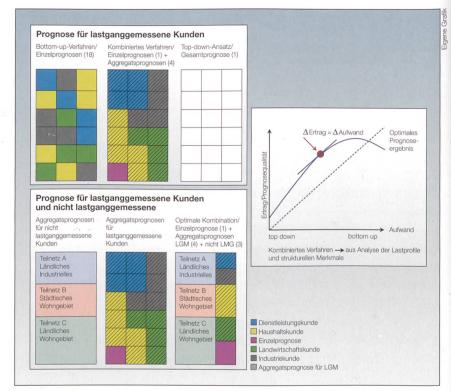
Bild 1 Analyse der Lastprofile und strukturellen Merkmale. Für ein optimales Prognoseergebnis sind die Grenzkosten und der Grenznutzen einer zusätzlichen Modell-
