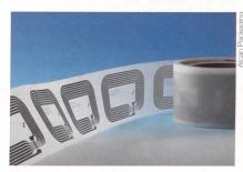
Die Herstellverfahren für RFID-Antennen in gedruckter Form ermöglichen effizientere Produktionsprozesse.
