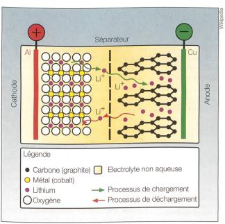
Figure 1 Structure d'un accumulateur au lithium-ion.
