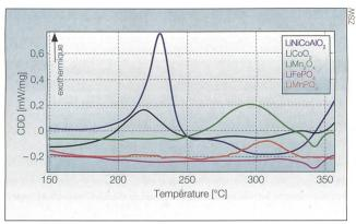
Figure 7 Calorimétrie différentielle dynamique (CDD) de quelques matériaux d'électrodes entièrement chargés [3].
