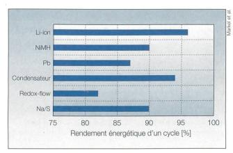
Figure 6 Degré d'efficacité du chargement/ déchargement de différents systèmes de batteries [1].
